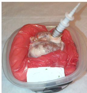
(a) Système de mousse pour maintenir le cœur
