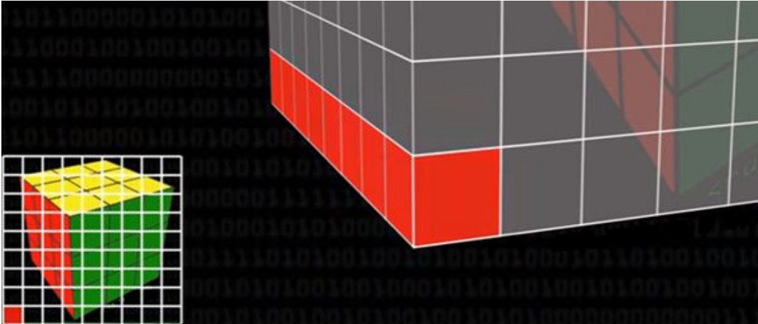
Figure 2.1: Exemple de projection d'une série de voxels dans une des images de la séquence
