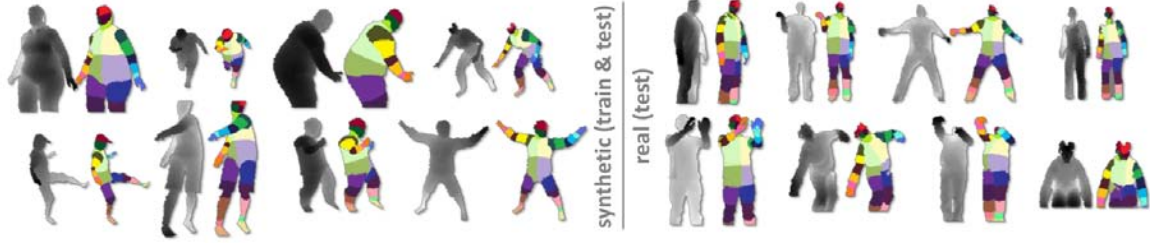
FIGURE 1.2 – Un extrait de la base d'apprentissage utilisée par Microsoft pour apprendre leur classificateur. À gauche les images synthétiques et à droite les images réelles. Pour chaque image de profondeur (en niveau de gris), un étiquetage est fait pour chaque pixel pour identifier la partie du corps à laquelle ce pixel appartient.
