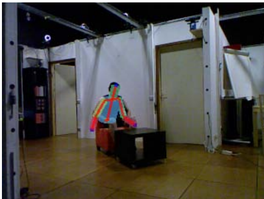
(e) Notre méthode réussit à détecter et éliminer les parties du corps cachées et à maintenir un suivi correcte de la partie supérieure du corps
