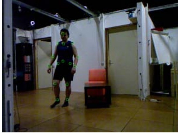
FIGURE 5.3 – Capture d’écran du programme fourni avec la base de données de capture de mouvement permettant d’afficher les marqueurs (cercles en vert) sur les images.
