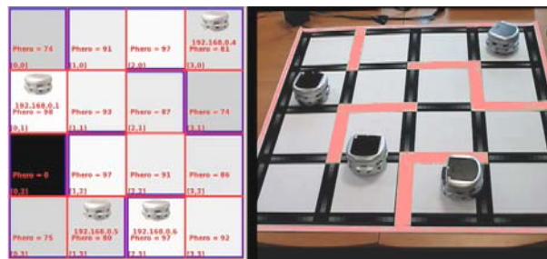
FIGURE 7.3 – Implémentation robotique d'EVAP sur l'émulateur de dalles
