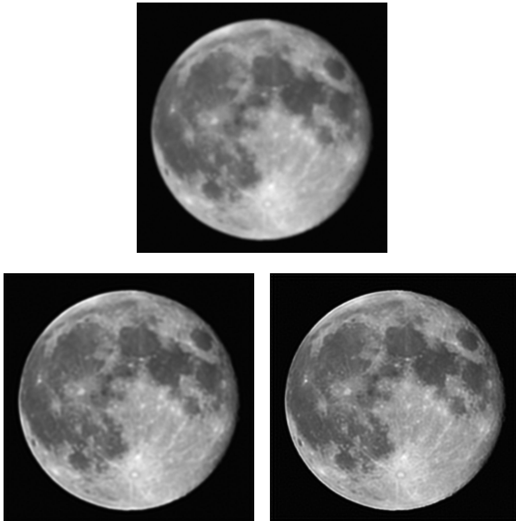
FIG. 3.7 – Algorithme de Richardson-Lucy. En haut, image originale. On choisit un filtre Gaussien de taille 21. En bas : après 10 itérations (à gauche), et après 100 itérations (à droite). La sensation de netteté s'améliore, des détails deviennent visibles.
