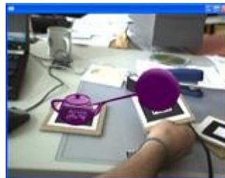
Sur un marqueur, affichez une sphère de rayon 5cm (*glutSolidSphere*) et un cône dont la base a un rayon de 0,5cm et une longueur de 20cm (*glutSolidCone*), orienté comme sur les captures d'écran.
